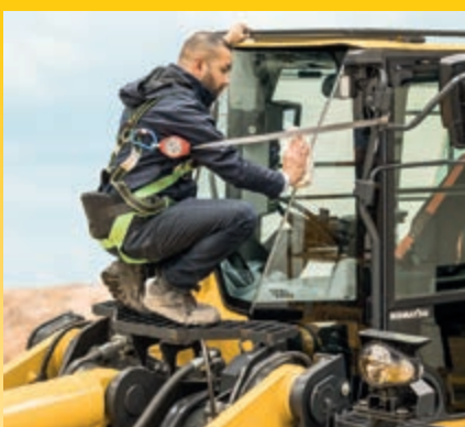
Escalón frontal para facilitar la limpieza del parabrisas y hacer la operación más segura
