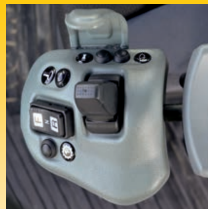
Palanca de dirección corta (K-SLS) (opcional)
