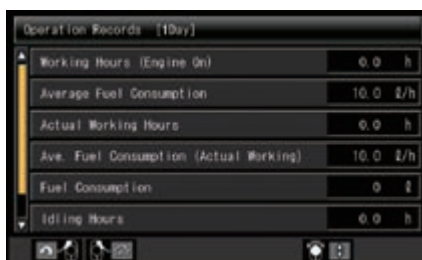
El monitor multifunción muestra y controla mucha información operativa y de mantenimiento
