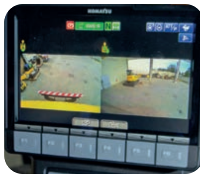
Sistema de cámara para visibilidad trasera y lateral
