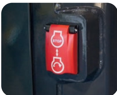
Interruptor de parada de emergencia del motor
