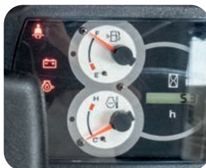
Indicador de aviso del cinturón de seguridad en el salpicadero
